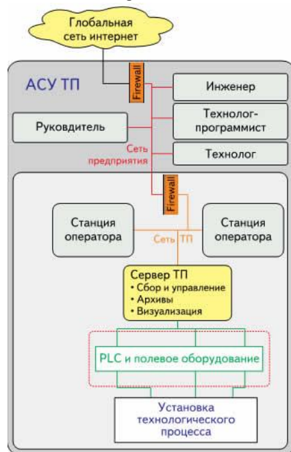
Рис. Обобщенная структурно-функциональная схема некоторой АСУ ТП (автоматизированной системы управления технологическим процессом). Студенту в отчете следует отобразить такого рода схему, соответствующую реальному состоянию дел на предприятии, назвать конкретную установку, конкретные PLC (ПЛК – программируемый логически контроллер), модули связи, датчики, исполнительные устройства
