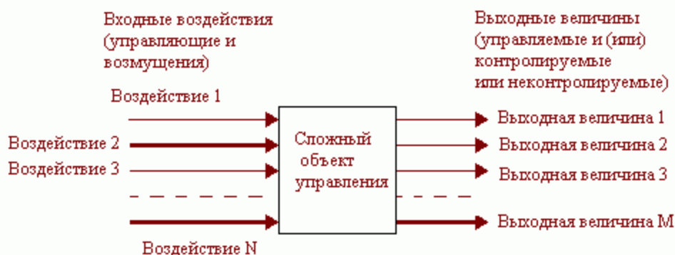
Рис. Функционально-структурная схема технологического агрегата, как многомерного объекта управления. Условно выделены: Воздействие 2, как управляющее, воздействие N, как главное возмущающее, а также выходная величина M, как управляемая величина конкретной САР, подлежащей рассмотрению и модернизации в дипломной работе
