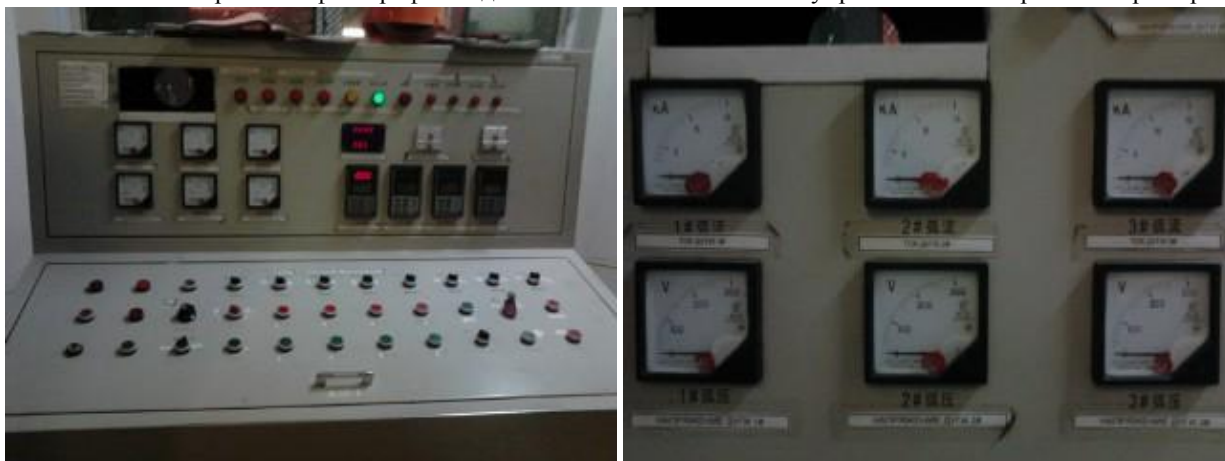
Рис. Пульт оператора сталеплавильной печи, амперметры и вольтметры токов электродов (электрических дуг). Это элементы контроля и управления системы устранения коротких замыканий
